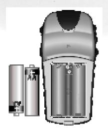
Extraiga las baterías de su eTrex Summit si no lo va a utilizar en varios meses. Asegúrese de observar la polaridad correcta. Siga las instrucciones del fabricante para el cuidado de las pilas.
