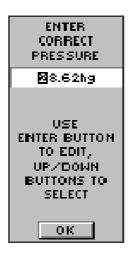
El eTrex Summit puede intentar la calibración automática del altímetro utilizando las lecturas de la altitud del GPS. Para un rendimiento óptimo del altímetro deberá realizar la calibración introduciendo o la altura o la presión barométrica correcta.
